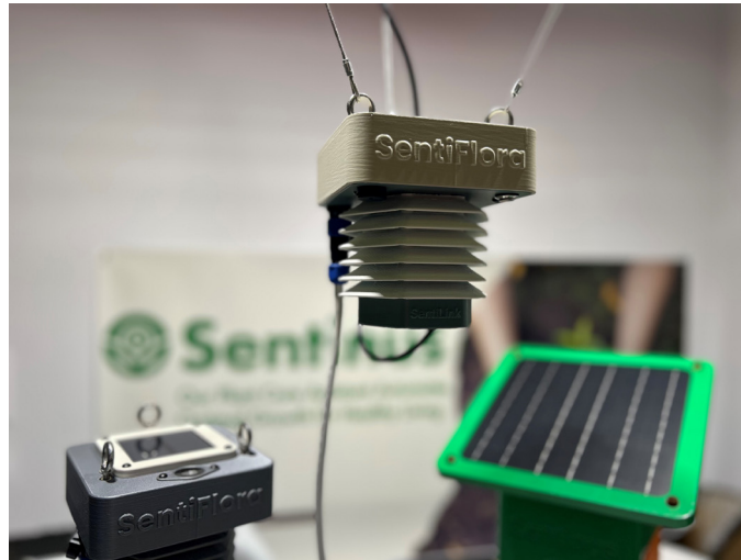
De gauche à droite : la version SentiFlora à panneau solaire, utilisée dans les serres trois-saisons ou à l'extérieur, SentiFlora pour serres quatre-saisons, alimentée par câble, boîtier SentiControl, équipé d'une batterie plus puissante et d'un panneau solaire assurant une meilleure autonomie.
